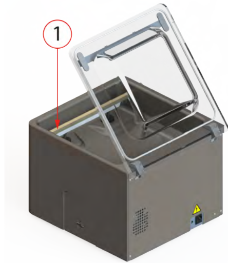
Schéma 6 : Retrait de la barre de soudure
