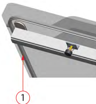
Schéma 9 : Remplacement du joint du couvercle
