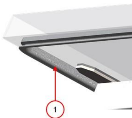
Schéma 23: Remplacement du joint du couvercle
