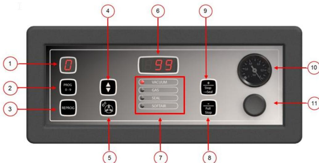
Schéma 7: Panneau de commande du système de commande 10 programmes
