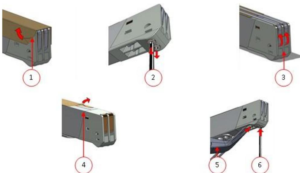
*Schéma 20: Remplacement de la résistance de soudure*
