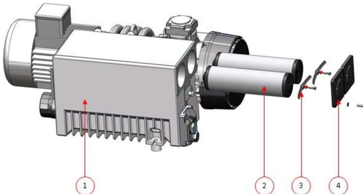
Schéma 17: Remplacement du filtre à échappement d'air (Pompe 76 m<sup>3</sup> / 2684 cf/h)
